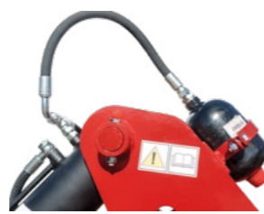
Suspensión por acumulador de nitrógeno
