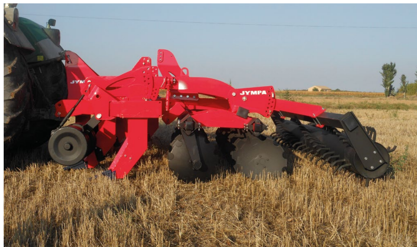
Modelo TANDEM-3000 con cuatro ruedas de nivelación metálicas
