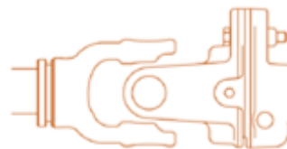
Nudo con tornillo fusible
