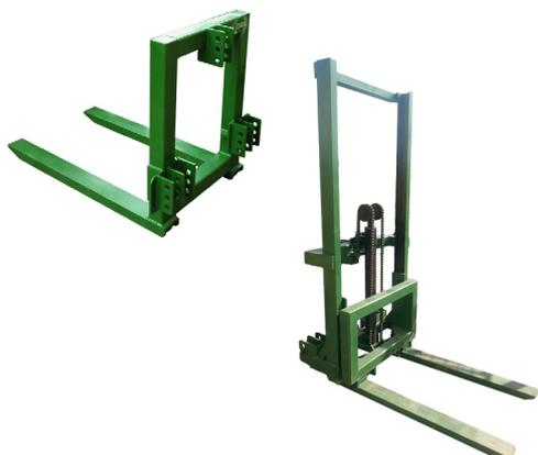
Nuestros Porta Palets puede montarse tanto en la parte trasera como delantera del tractor y suelen ser de dos tipos, fijos o hidráulicos. Este último consiste esencialmente en unas barras verticales que mediante un cilindro mueven una horquilla verticalmente.
